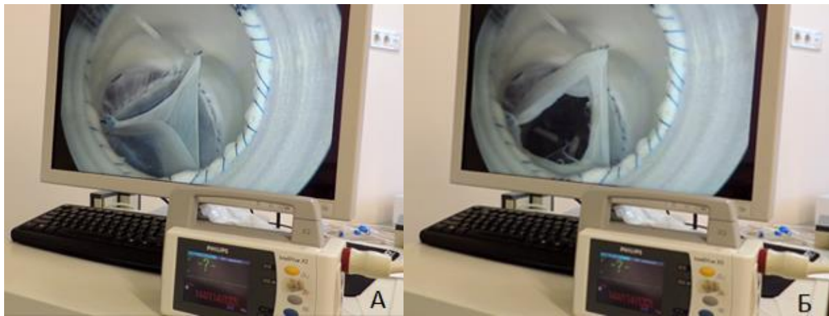
Рисунок 5.1.2.А. Експеримент №11: кінець діастоли - повне змикання стулок (АТ 144/114 (132) мм рт ст.)
